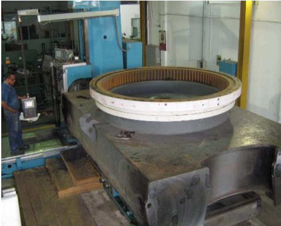
REPARACION PALA- SECTOR MINERO
